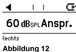
Beim MA 25e/MA 27e aktivieren Sie die Patientenansprache, indem Sie den Drehregler **Hearing Level dB (Hörpegel dB)** (2) gedrückt halten. Wenn Sie den Drehregler drehen, während Sie sich im Patientenansprache-Modus befinden, wird der Pegel der Patientenansprache an den Patienten angepasst (Abbildung 12).
