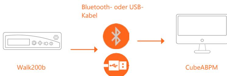
**Stand-alone-Nutzung** : Prüfungen können von Rekordern über Bluetooth oder USB-Kabel in die CubeABPM-Software heruntergeladen, um analysiert, gemeldet und archiviert zu werden.
